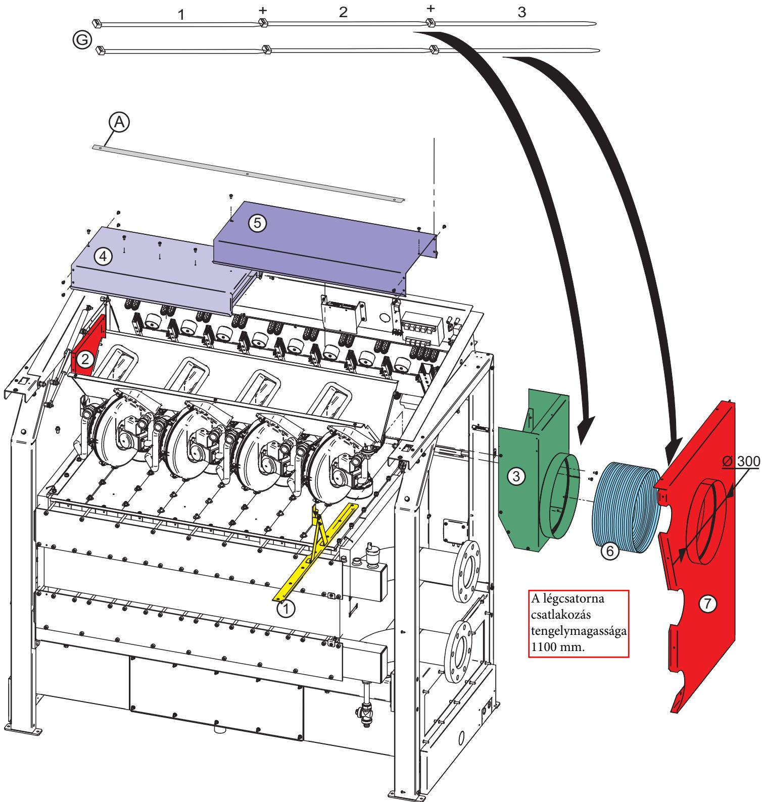
**Fissare la staffa di aggancio camera fumi "1", fissare la chiusura "2" , il terminale camera fumo "3". Chiudere la camera ventilatori mediante i coperchi telescopici 4+5 e bloccare la camera ventilatori con la staffa di chiusura "A".**
